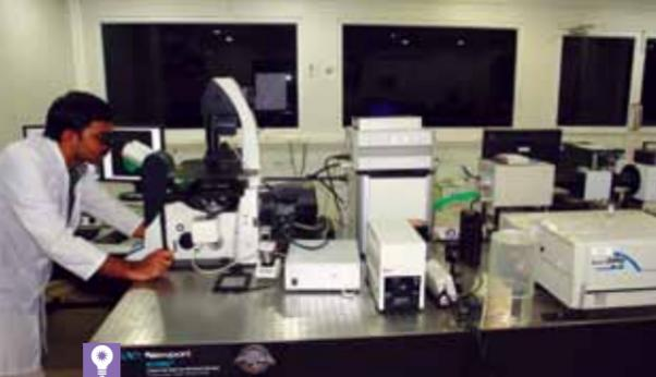
*Microscopio confocal laser para ver estructuras en células con seccionado óptico.*
